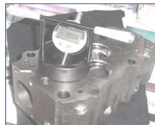
En la fabricación y ensamble de cabezas de motor diesel se presentaba una constante incidencia de defectos en el ensamble de guías y asientos de válvulas, básicamente excentricidad entre ambos, aun cuando las partes primarias cumplía con los estándares de calidad; por ello la empresa
